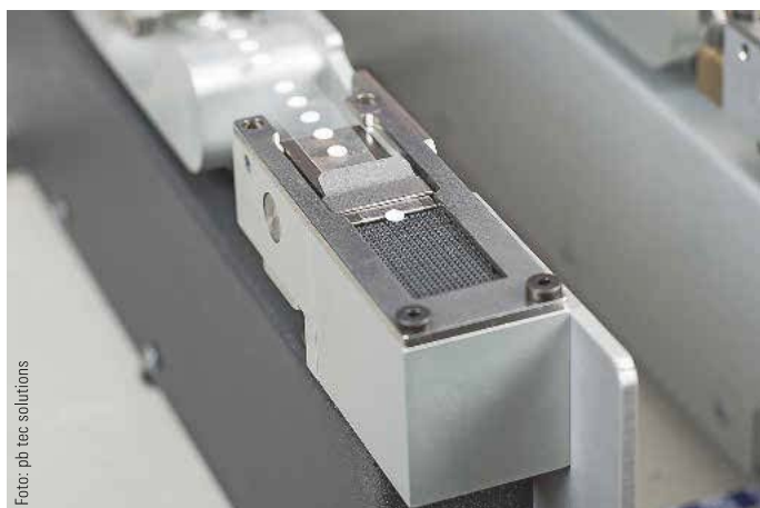
Zuführung eines Sensors von 3 mm Durchmesser.
