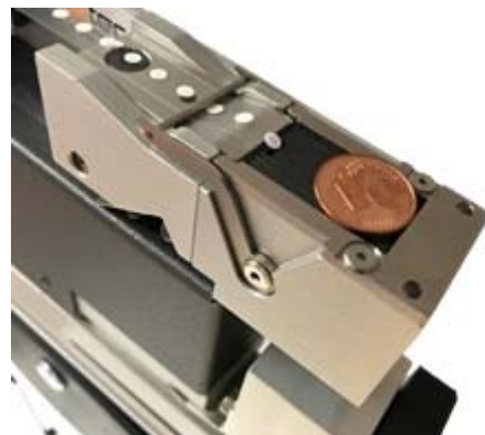
Zuführung eines runden Druckausgleichselements (DAE), 2 mm Durchmesser
